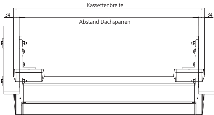
Pict 4.20: Sondervariante Dachsparrenbefestigung vertauscht mit Dachsparrenhalter und Montageplatte. Special variant rafter assembly interchanged with rafter bracket and mounting plate
